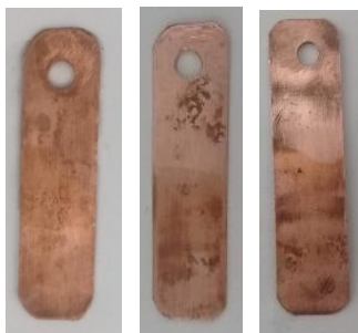
Gambar 4 Hasil Pembentukan Amalgam Pada Tembaga Pada Konsentrasi 5%HgCl 2 pengulangan 1,2,3
