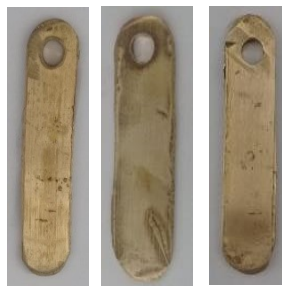
Gambar 5. Hasil Pembentukan Amalgam Pada Kuningan Pada Konsentrasi 5 % HgCl 2 pengulangan 1,2,3
