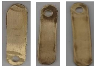
Gambar 14. Hasil Pembentukan Amalgam Pada Kuningan Pada Konsentrasi 2% HgCl 2 pengulangan 1,2,3
