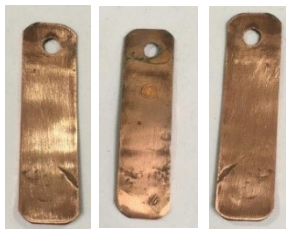
Gambar 13 Hasil Pembentukan Amalgam Pada Koin 500 Emas Pada Krim Pemutih BPOM pengulangan 1,2,3
