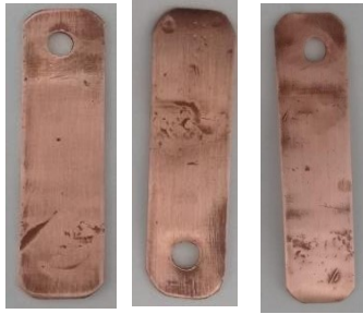
Gambar 10 Hasil Pembentukan Amalgam Pada Tembaga Pada Konsentrasi 3% HgCl 2 pengulangan 1,2,3
