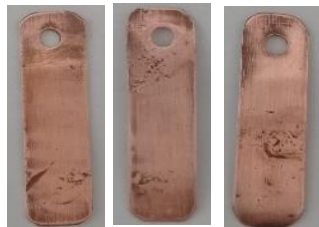
Gambar 7. Hasil Pembentukan Amalgam Pada Tembaga Pada Konsentrasi 4 % HgCl 2 pengulangan 1,2,3
