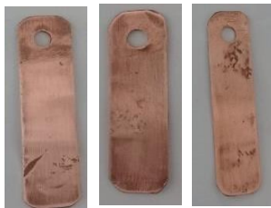
Gambar 13 Hasil Pembentukan Amalgam Pada Tembaga Pada Konsentrasi 2% HgCl 2 pengulangan 1,2,3
