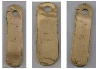
Gambar 8. Hasil Pembentukan Amalgam Pada Kuningan Pada Konsentrasi 4 % HgCl 2 pengulangan 1,2,3
