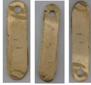
Gambar 11. Hasil Pembentukan Amalgam Pada Kuningan Pada Konsentrasi 3% HgCl 2 pengulangan 1,2,3
