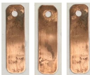
Gambar 16 Hasil Pembentukan Amalgam Pada Koin 500 Emas Pada Krim Pemutih Non BPOM pengulangan 1,2,3
